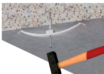
Einschlagen in die Decke
